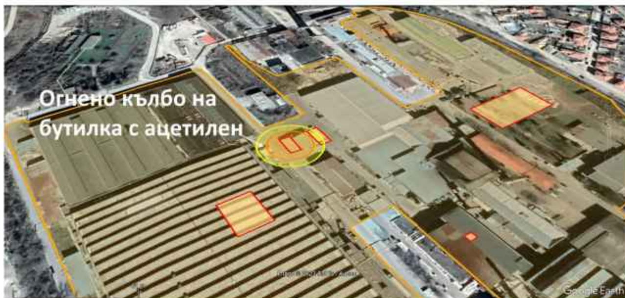
Фигура IV.1.1-3 Зони на поражение при огнено кълбо на бутилка с ацетилен
