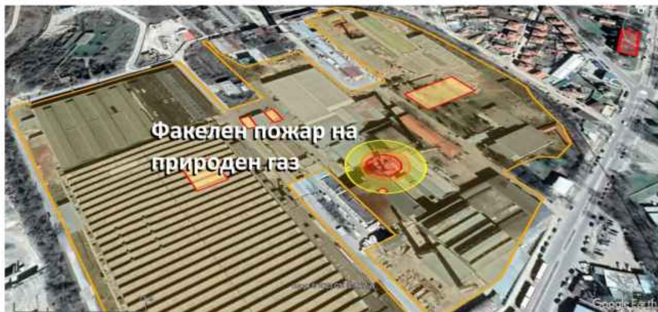
Фигура IV.1.1-1 Зони на поражение при факелен пожар на природен газ
