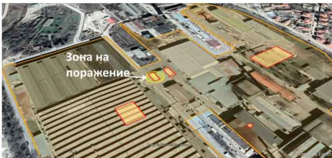
Фигура IV.1.1-2 Зони на поражение при факелен пожар на бутилка с ацетилен
