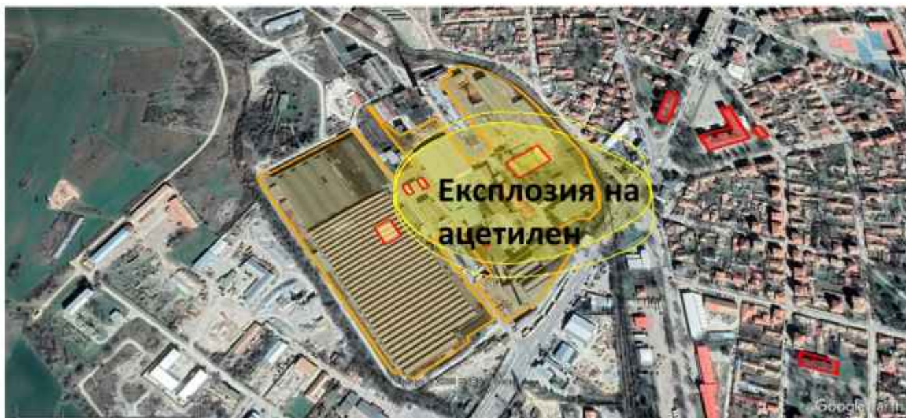
Фигура IV.1.1-4 Зони на разрушения при експлозия на 4.32 t ацетилен
